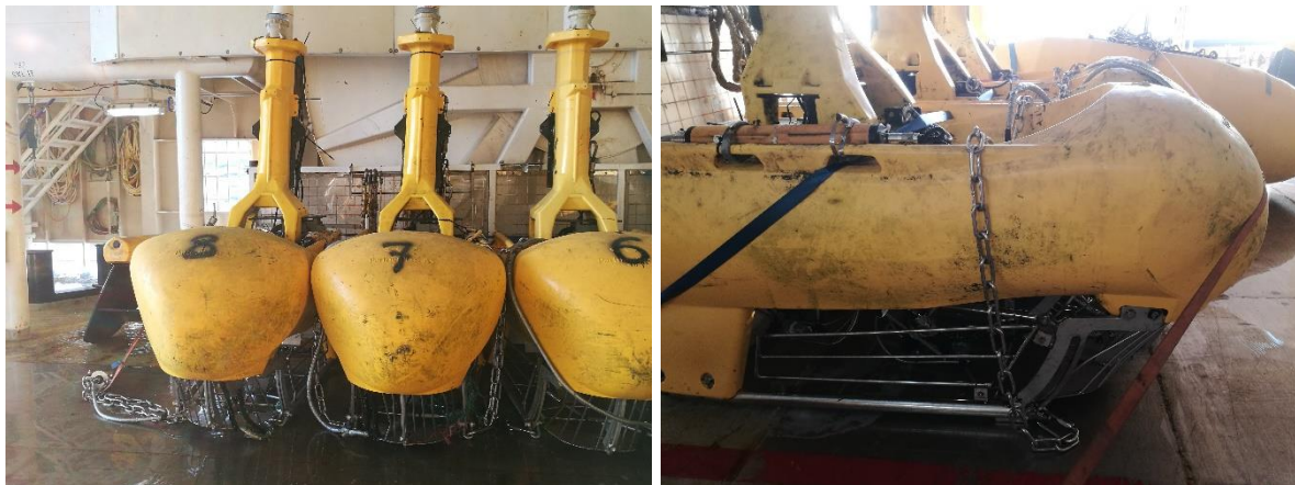
Figura 3. Imágenes de los protectores de tortuga de exclusión instalados en las boyas de cola de los streamers del buque sísmico BGP PROSPECTOR.
